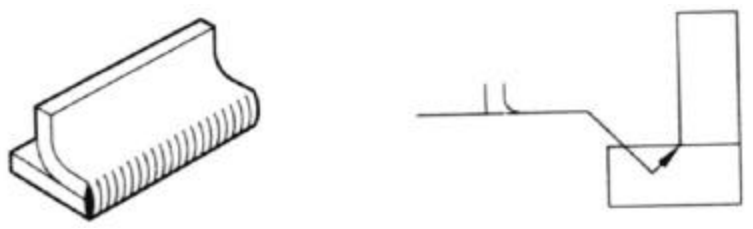
Figura 2.17 – Solda em Peça Curva ou Flangeada e uma Peça Plana
