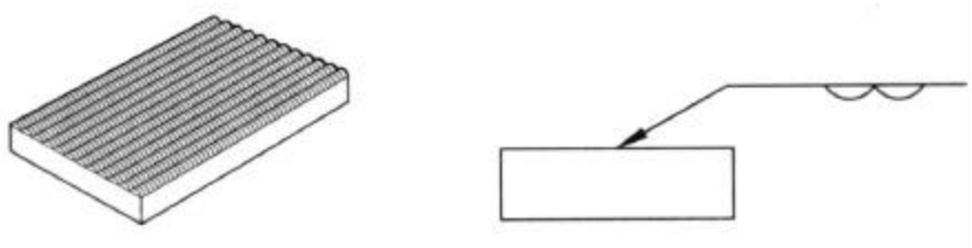
Figura 2.11 – Solda de Revestimento
